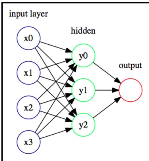
Рисунок 15 – Схема нейросети с одним скрытым слоем
