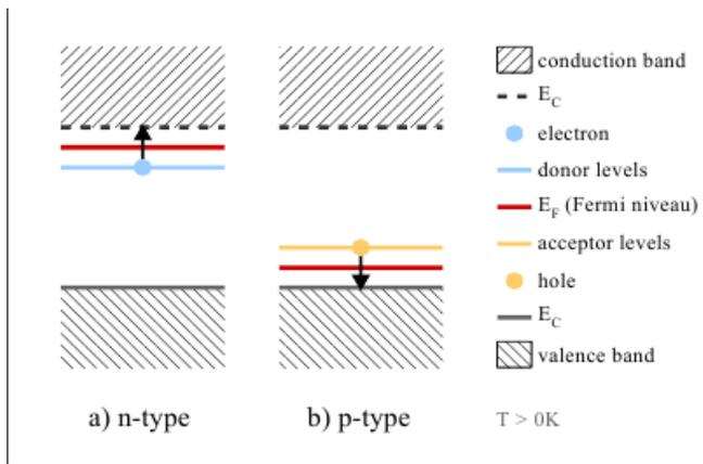
Рисунок 4 – Полупроводники р и n типа
