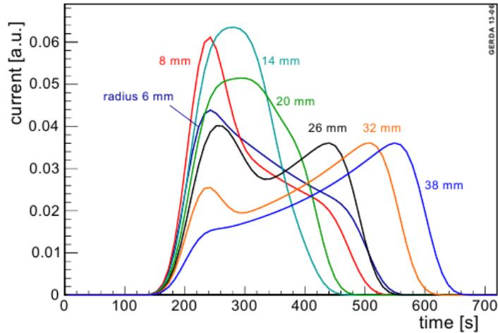
Рисунок 11 – Оциллограмма для SSE для полукоаксиальных детекторов
