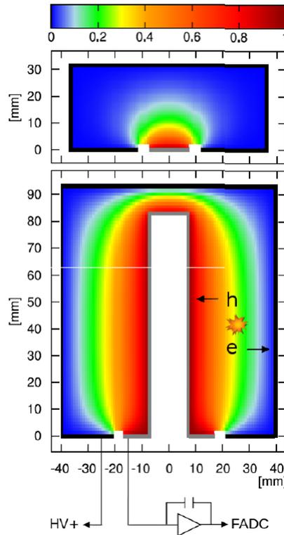
Рисунок 7 – Схема полукоаксиальных (снизу) и BEGe (сверху) детекторов
