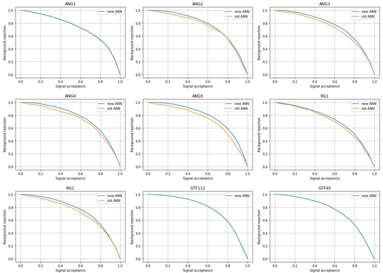
Рисунок 18 – ROC-кривые для каждого детектора. Background rejection - TNR (1-FPR), signal efficiency - TPR
