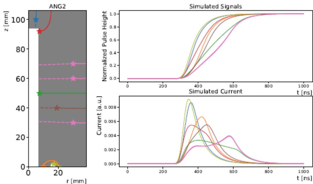
Рисунок 14 – Возможные формы импульсов для разных мест выделения энергии в полукоаксиальном детекторе. Звездочками обозначены события, пунктиром - траектории, вдоль которых перемещаются дырки, сплошной линией - траектории, вдоль которых перемещаются электроны
