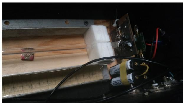
Рис. 3.2: Детектирующий элемент установки: сборка SiPM, предусилитель, питаемый от батарей, вывод сигнала
