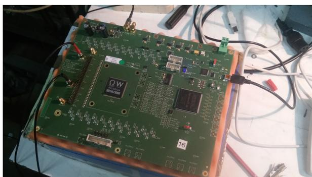
Рис. 3.3: Интегральная схема специального назначения PETIROC2A
