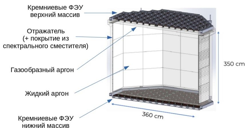
Рисунок 2.1 — Конструкция детектора
