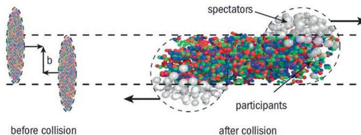
Рисунок 6 — Упрощенная геометрия столкновения двух тяжелых ионов.
