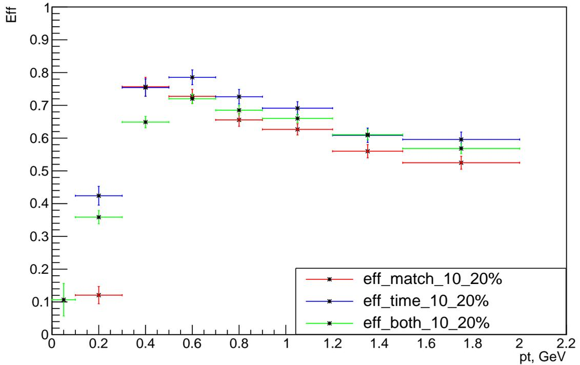
Рисунок 24 — Зависимость эффективностей критериев от поперечного импульса для диапазона центральностей 10-20%
