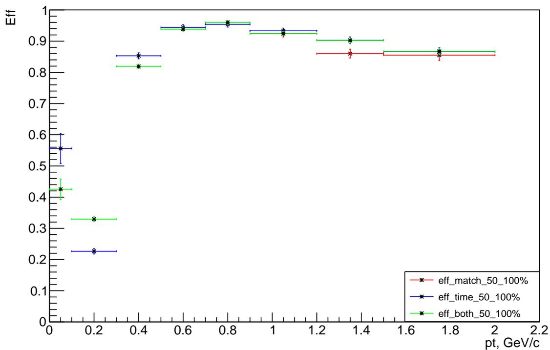
Рисунок 27 — Зависимость эффективностей критериев от поперечного импульса для диапазона центральностей 50-100%
