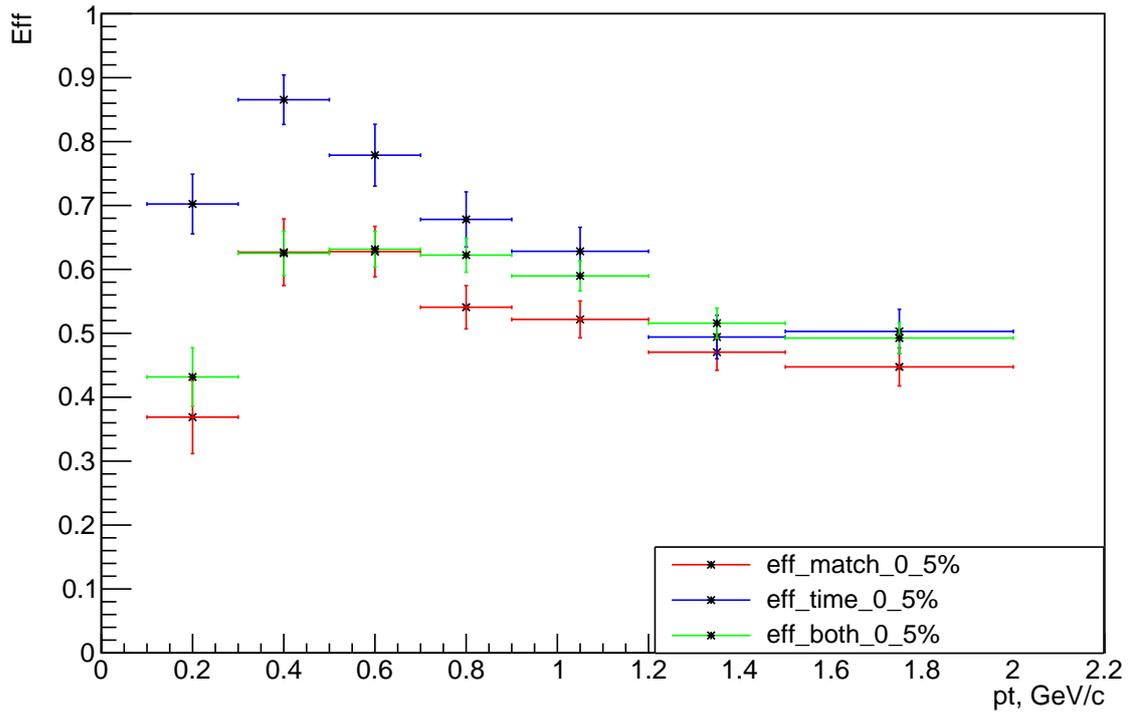
Рисунок 22 — Зависимость эффективностей критериев от поперечного импульса для диапазона центральностей 0-5%
