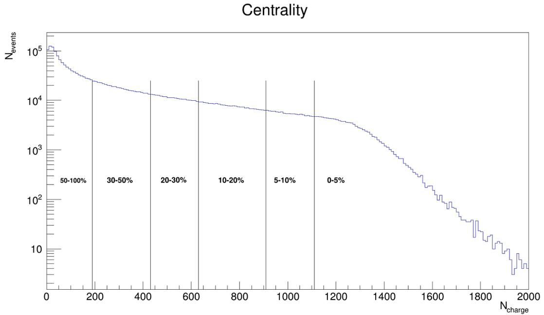
Рисунок 8 — Зависимость числа событий от числа заряженных частиц. Разбиение на классы центральностей
