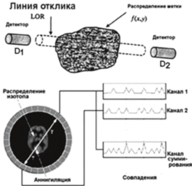
Рисунок 1.8 — Схема совпадений в ПЭТ камере
