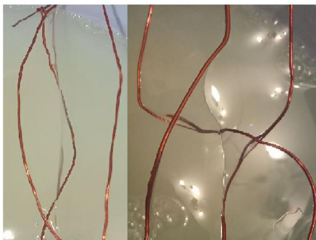
Рисунок 1.5 — Плёнки на двух косах. В первом случае имеется одна водяная линия. Во втором - две
