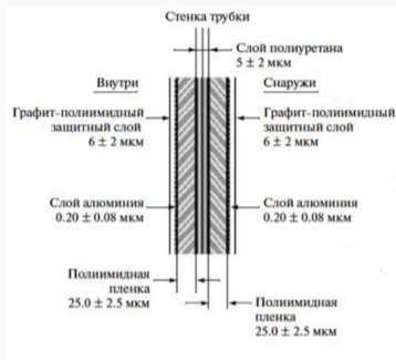
Рис. 1: Строение стенки трубки
