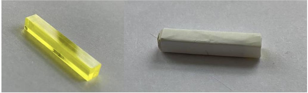
Рисунок 9: пример внешнего вида кристаллов до(слева) и после(справа) нанесения диффузного светоотражателя
