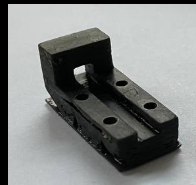
Рисунок 7 Установка для проведения измерений с кристаллами GAGG двумя SiPM и позитронным источником
