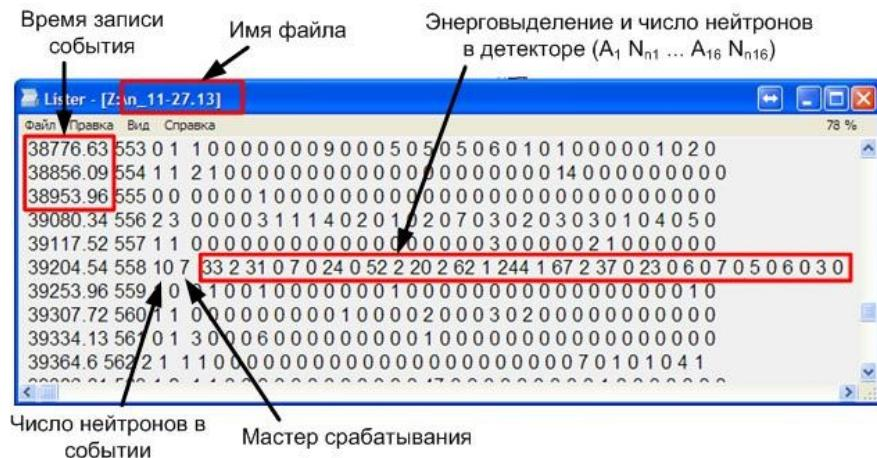
Рисунок 2.6 — Пример записи файла с основными параметрами зарегистрированных событий.
