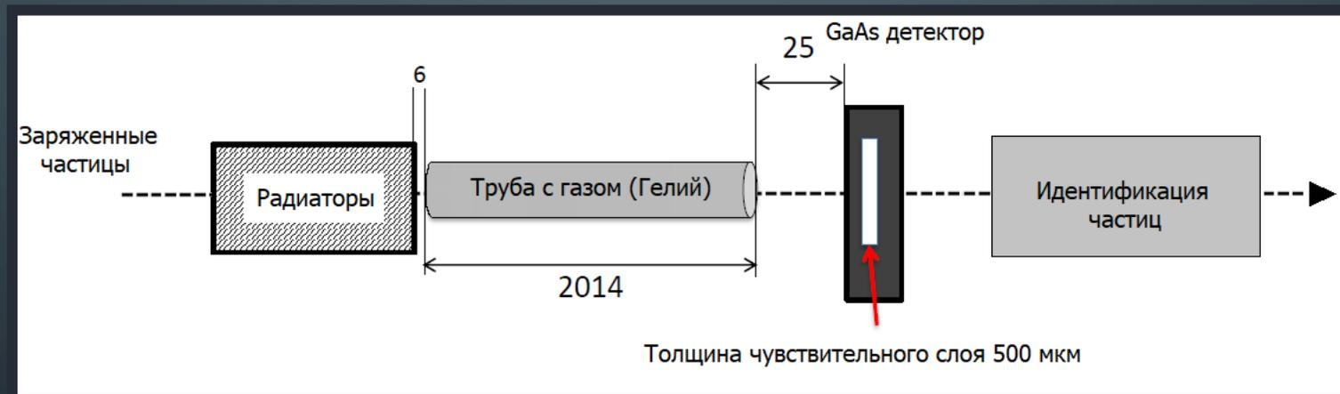
*Схематическое представление экспериментальной установки*
