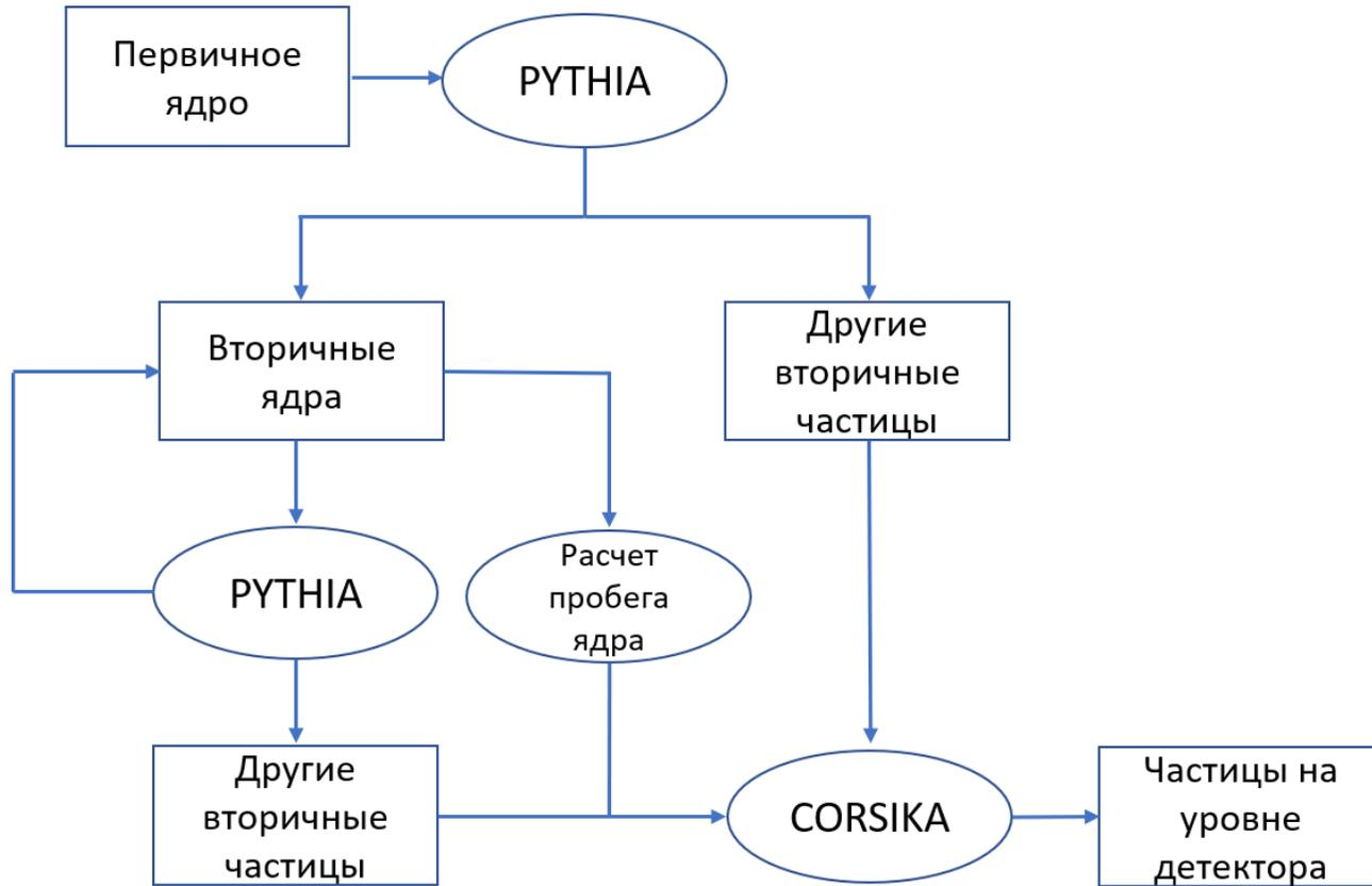
Общая схема интерфейса. Использовалась опция «STACKIN» для моделирования ШАЛ в CORSIKA, по списку частиц первого взаимодействия.
