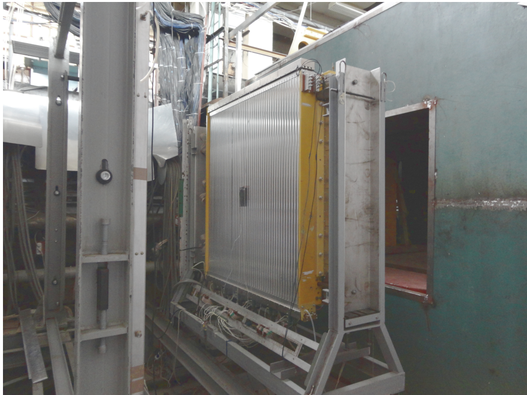
Рисунок 1.3 — Внешний вид одного из дрейфовых детекторов ОКА на рабочей позиции за 2-м спектрометрическим магнитом СП-40. В середине апертуры детектора закреплен сцинтилляционный счетчик в области прохождения пучка.
