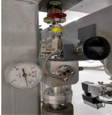
(а) Внешний вид системы подачи системы подачи азота в перезарядное устройство. Рабочее давление для азота – 1.5 атм.
