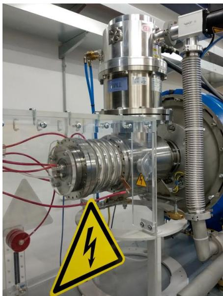
Рис. 3: Внешний вид ионного источника
