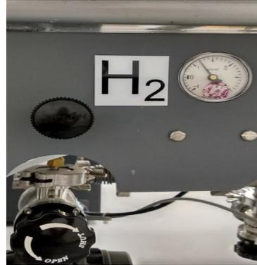
(б) Внешний вид системы подачи водорода для ионного источника. Рабочее давление для водорода 1.0 – 1.3 атм.
