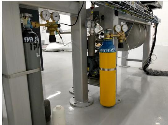
Рис. 6: Внешний вид газовой системы ионного источника и перезарядного устройства: серый баллон – баллон с азотом ( $N_2$ ), желтый баллон – баллон с водородом ( $H_2$ )
