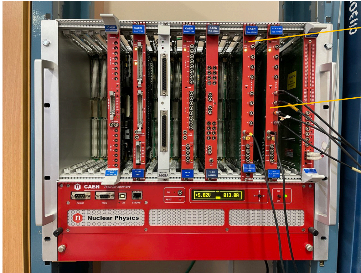
Рисунок 4 - Крейт VME с установленными модулями ADC(АЦП) и QDC(ЗЦП)
