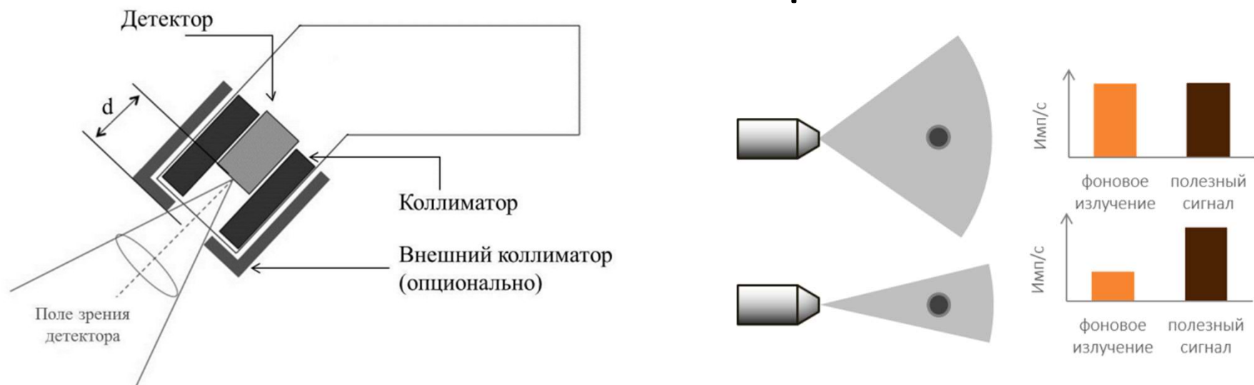
Схематичное изображение блока (щупа) гамма-зонда
