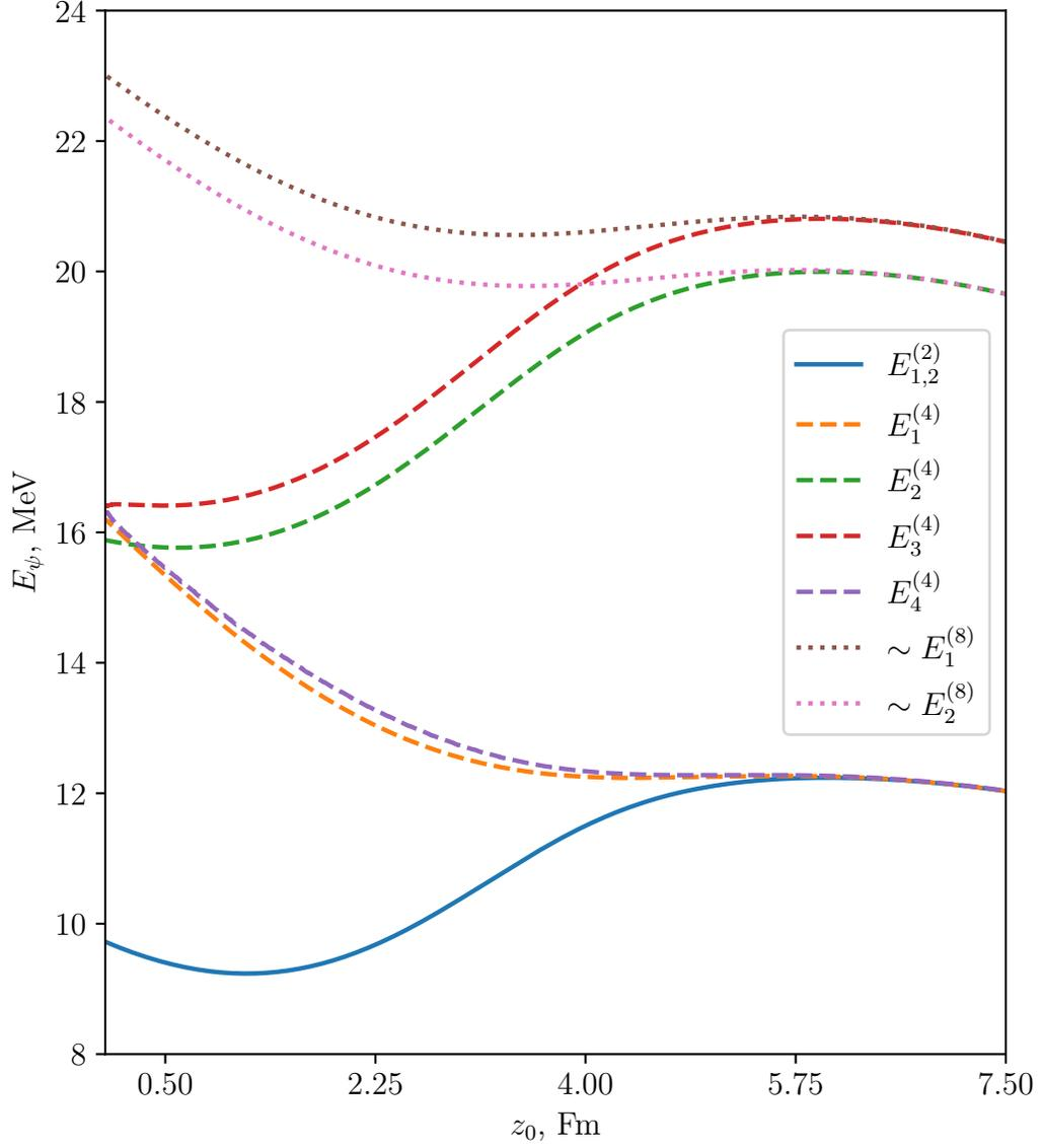
Рисунок 9.1 — Энергетические уровни двухцентрового осциллятора со спин-орбитальным взаимодействием в первом приближении.
