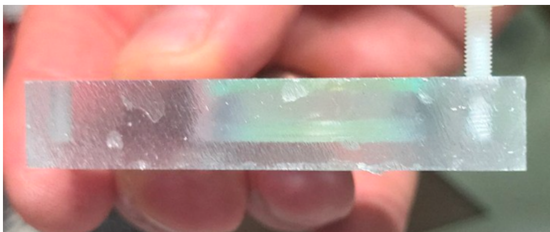
Рисунок 19 – Иллюстрация смачивания поверхности клеем
