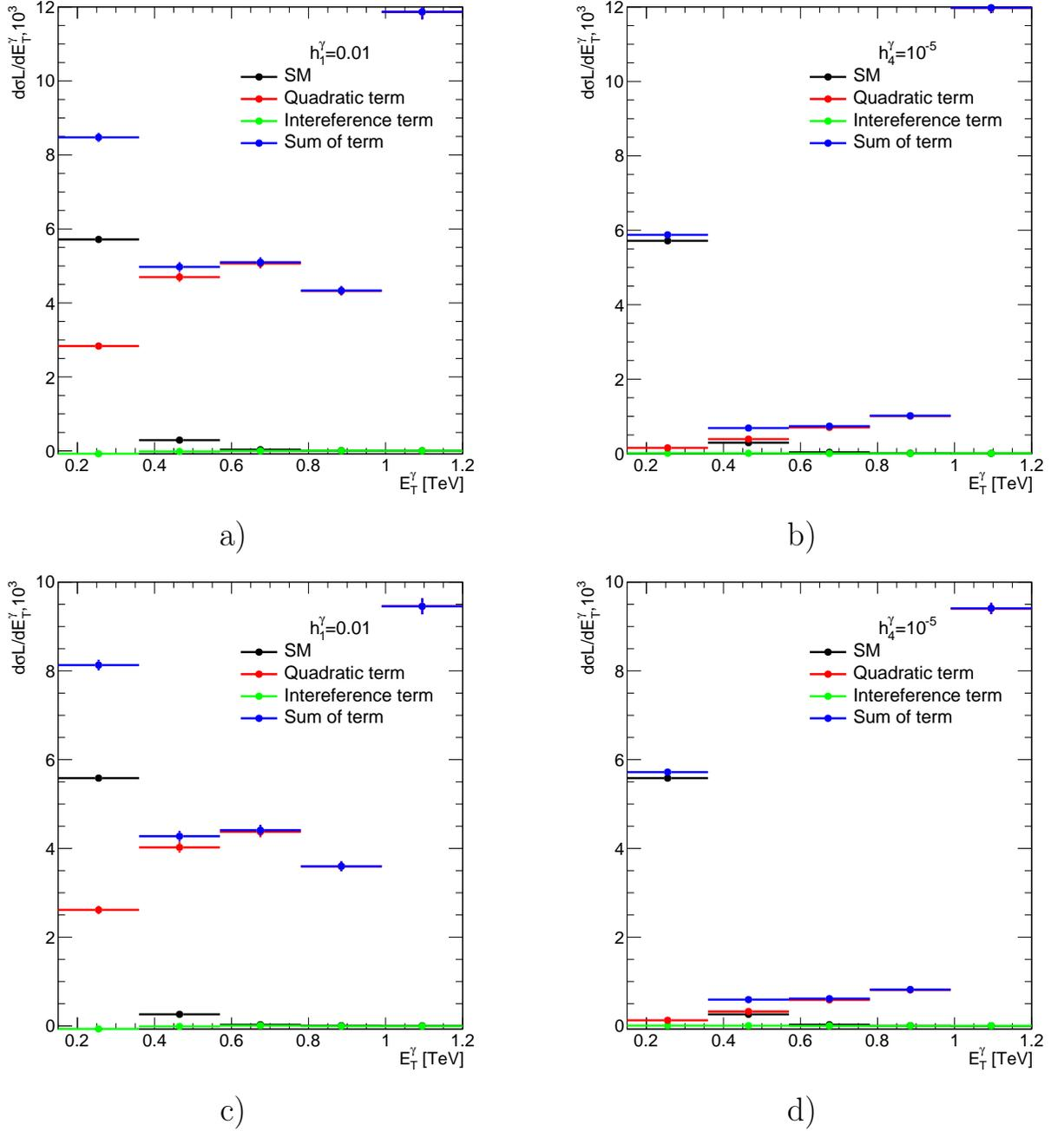
Рисунок 11 — Распределения по поперечному импульсу фотона для СМ, квадратичного, линейного слагаемых и их суммы для коэффициентов: а)  $h_1^\gamma = 0.01$  б)  $h_4^\gamma = 10^{-5}$  в)  $h_4^\gamma = 0.01$  с нулем струй д)  $h_4^\gamma = 10^{-5}$  с нулем струй.
