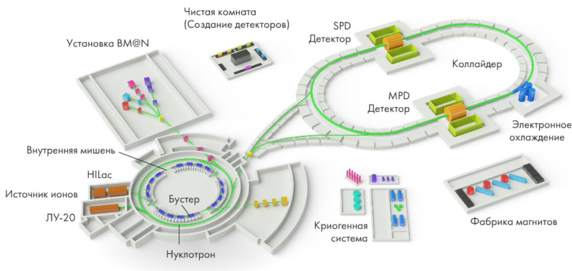
Рисунок 1.1 — Схема расположения основных ускорителей и экспериментальных установок коллайдерного комплекса NICA
