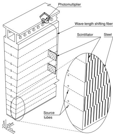
Fig. 1- Tile Calorimeter wedge module [1].
