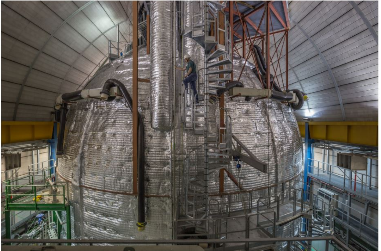
Рисунок 2.3 — Внешний водный резервуар детектора Борексино после установки теплоизоляции и системы активного контроля температуры [16]
