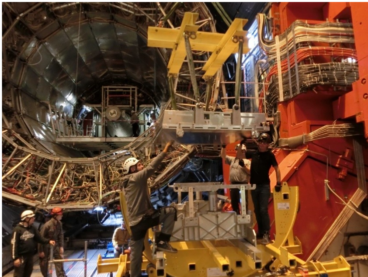
Установка отремонтированных модулей калориметра и вето-детектора заряженных частиц в шахту эксперимента АЛИСА на БАК (конец 2019 г.)
