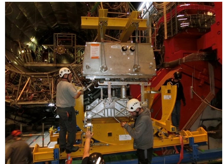
Установка отремонтированных модулей калориметра и вето-детектора заряженных частиц в шахту эксперимента АЛИСА на БАК (конец 2019 г.)
