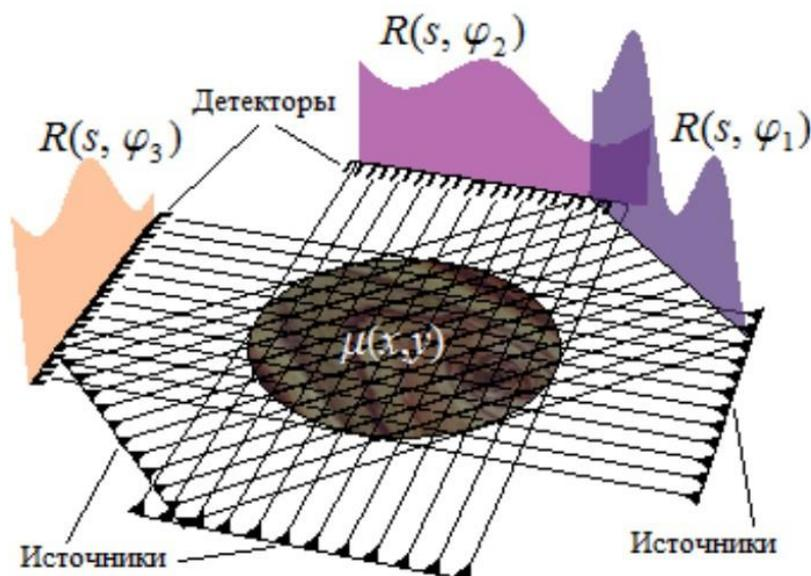
Рис. 6. Схема получения проекций  $R(s, \varphi)$  одного слоя.
