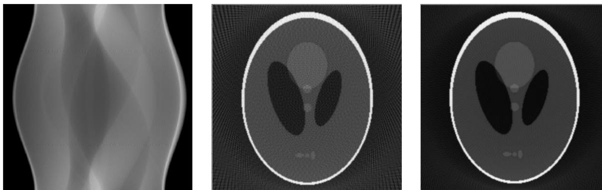
Рис. 4. 1 – синограмма; 2 – томограмма (число проекций 90); 3 – томограмма (число проекций 180).
