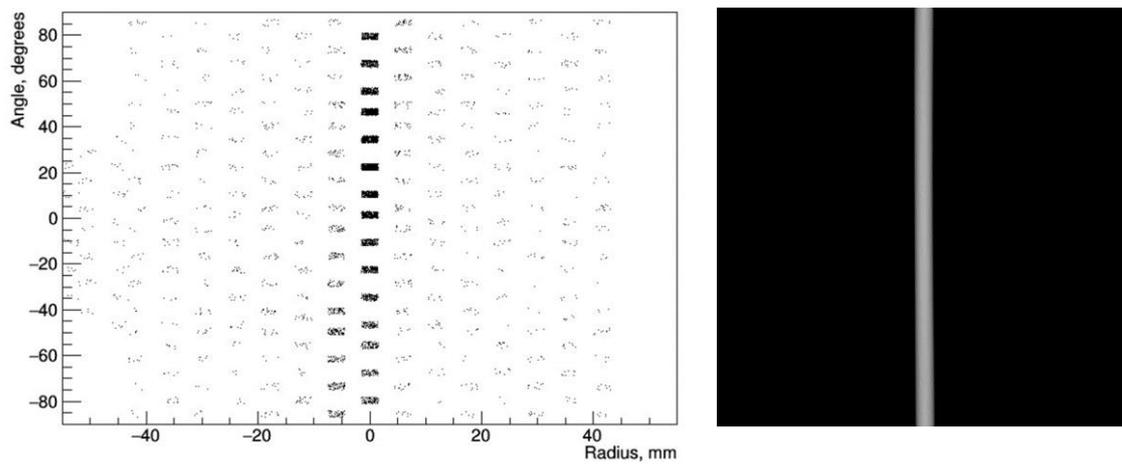
Рис. 10. Синограмма реального источника, расположенного по центру (слева) и имитация источника (справа).
