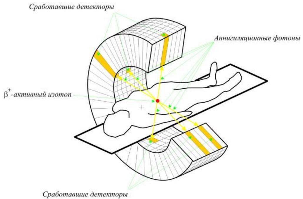
Рис. 2. Принцип работы ПЭТ.
