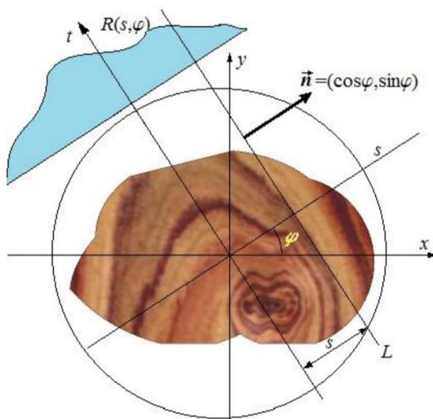
Рис. 7. К преобразованию Радона функции двух переменных.
