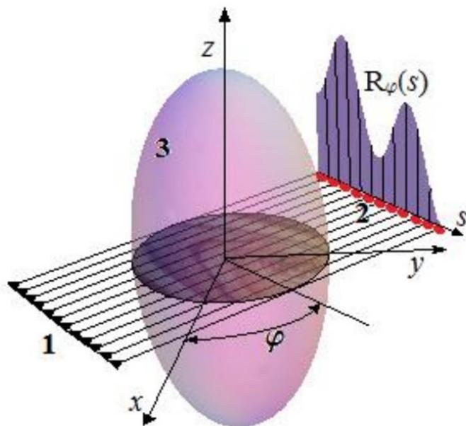
Рис. 5. Зондирование трехмерного объекта (1 – источники; 2 – детекторы; 3 – объект).
