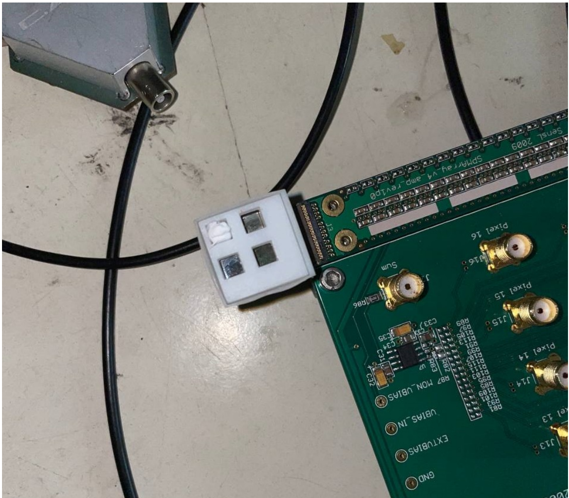
Рисунок 25 — Установленная на матрицу маска для точного позиционирования калибровочного сцинтилляционного кристалла
