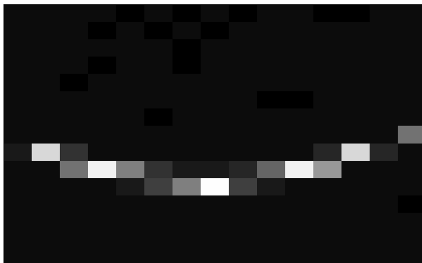
Рисунок 10 — Синограмма с микроПЭТ на 32 канала
