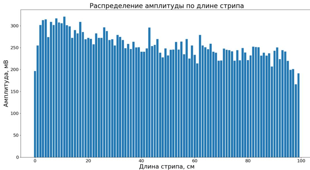
Распределение амплитуд сигналов-откликов в зависимости от координаты попадания мюона в стрип
