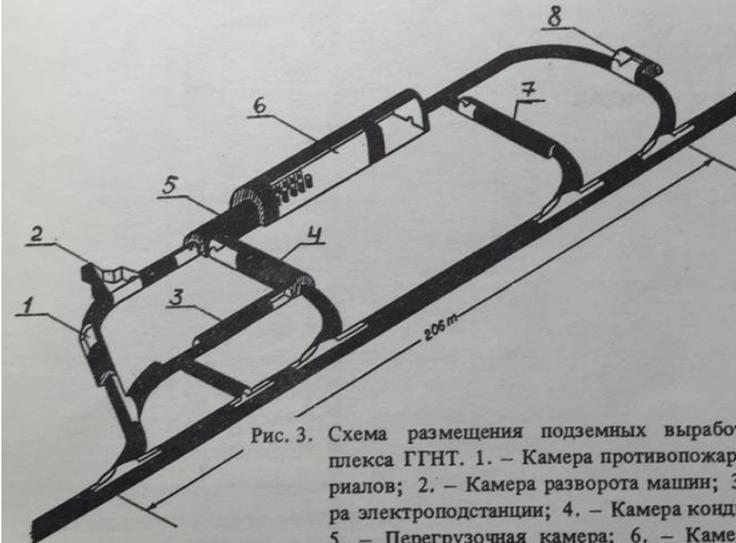
Рис. 3. Схема размещения подземных выработок комплекса ГГНТ. 1. – Камера противопожарных материалов; 2. – Камера разворота машин; 3. – Камера электростанции; 4. – Камера кондиционера; 5. – Перегрузочная камера; 6. – Камера ГГНТ; 7. – Камера вспомогательного технологического оборудования; 8. – Камера вытяжной вентиляционной установки. (Масштаб 1 : 1000).
