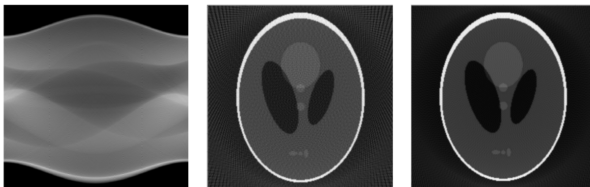
Рис. 4. 1 – синограмма; 2 – томограмма (число проекций 90); 3 – томограмма (число проекций 180).
