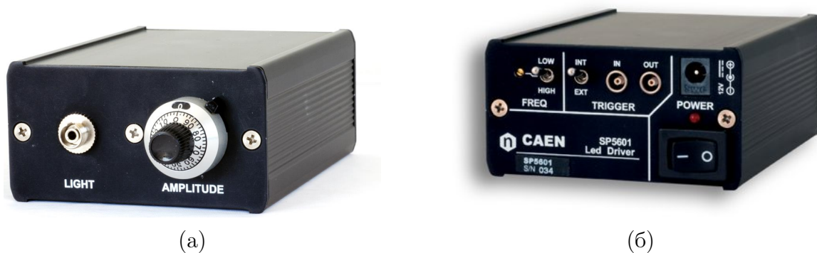
Рис. 2.1 — Фронтальная (а) и тыльная (б) торцевые части CAEN SP5601
