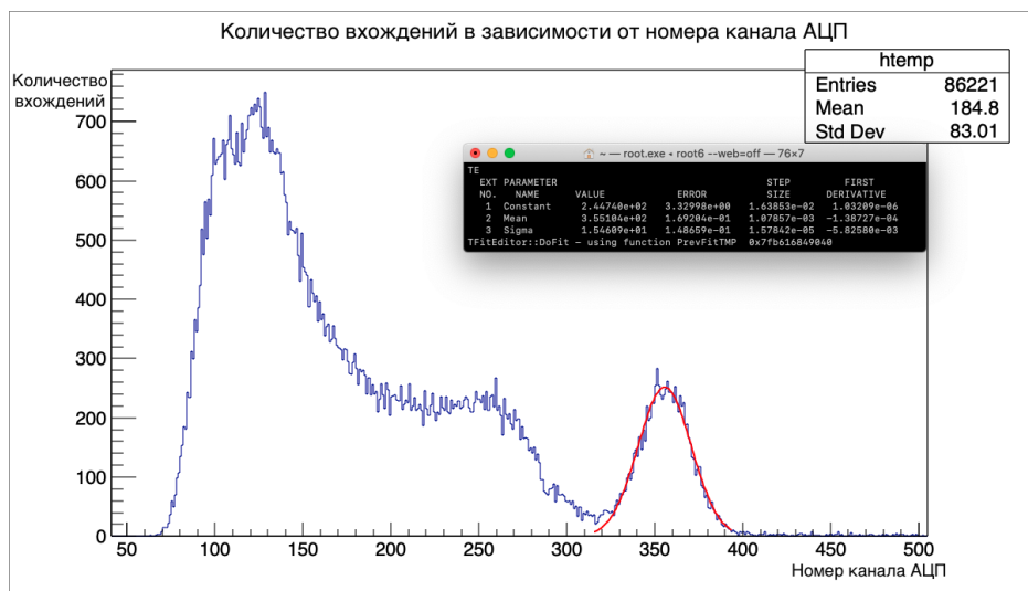
Рисунок 1.6 — Спектр источника ^{137}\text{Cs} , полученный на установке для тестирования кремниевых фотоумножителей и сцинтилляционных кристаллов
