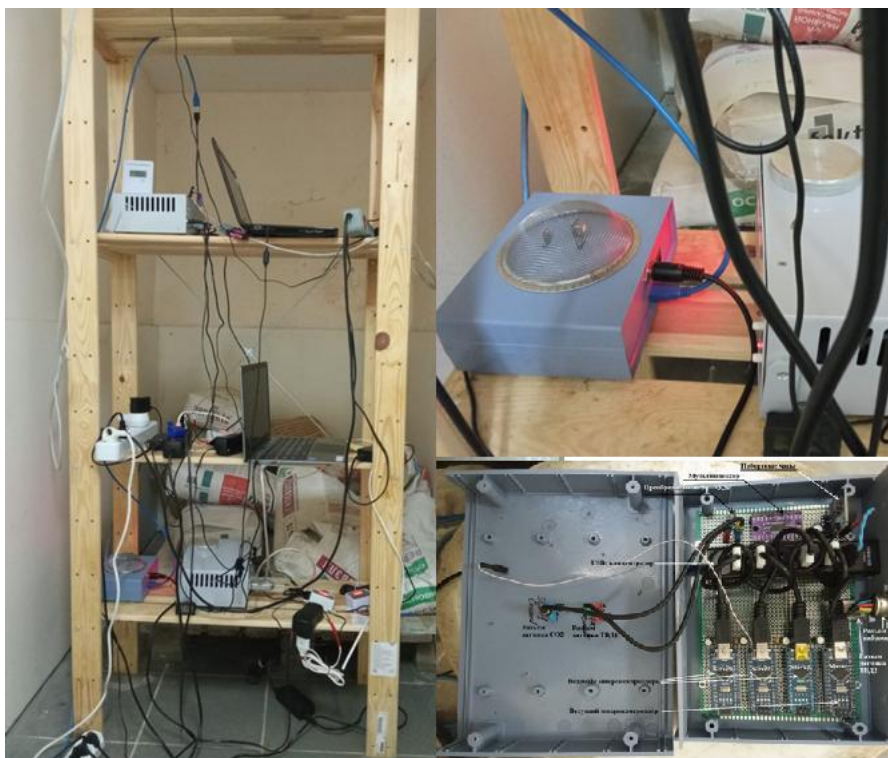
Рис.1. Фотографии измерительной станции (Сапфир-3м, датчики ТВД, датчик CO 2 )
