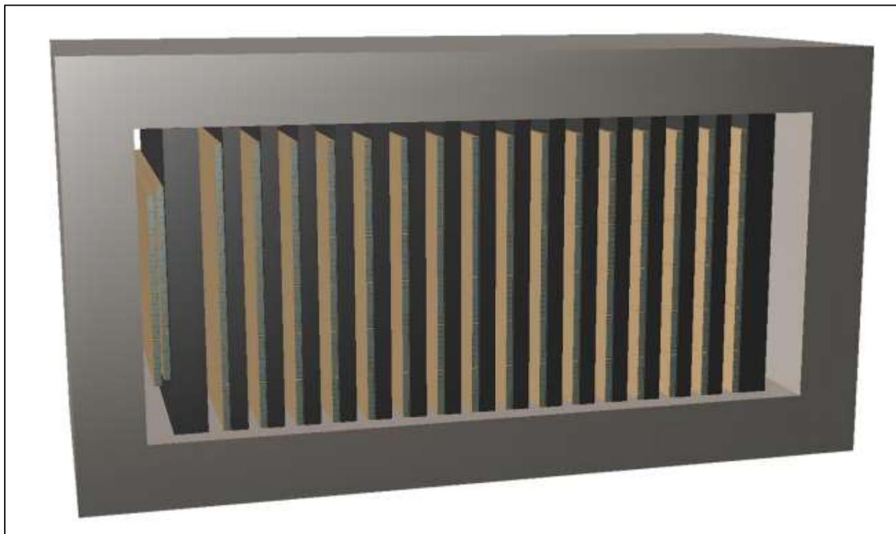
Рис. 5 Геометрическая модель прототипа мюонной системы SPD
