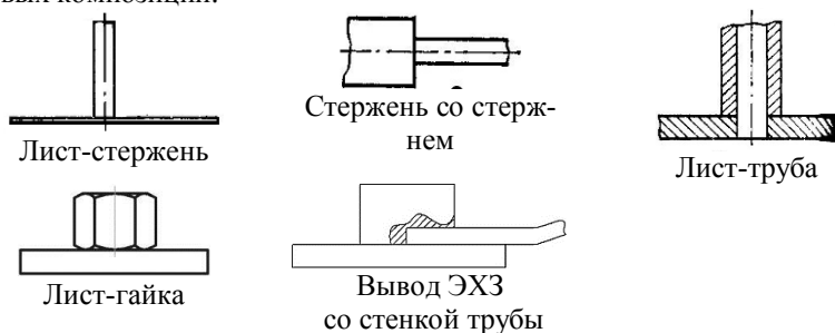
Рисунок 2 – Конструктивные виды сварных соединений
