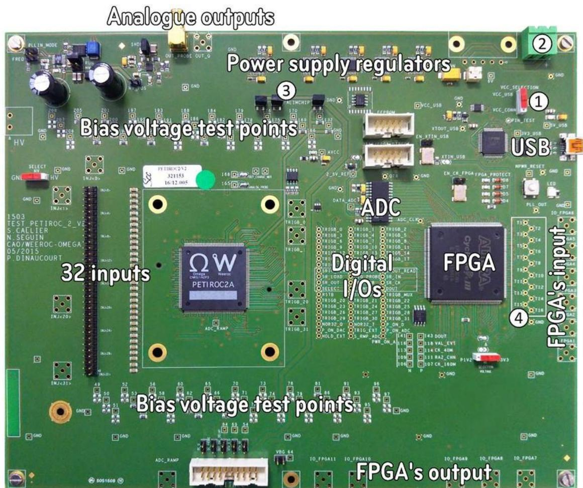
Рис. 10 - Тестовая плата Petiroc2A (вид сверху)
