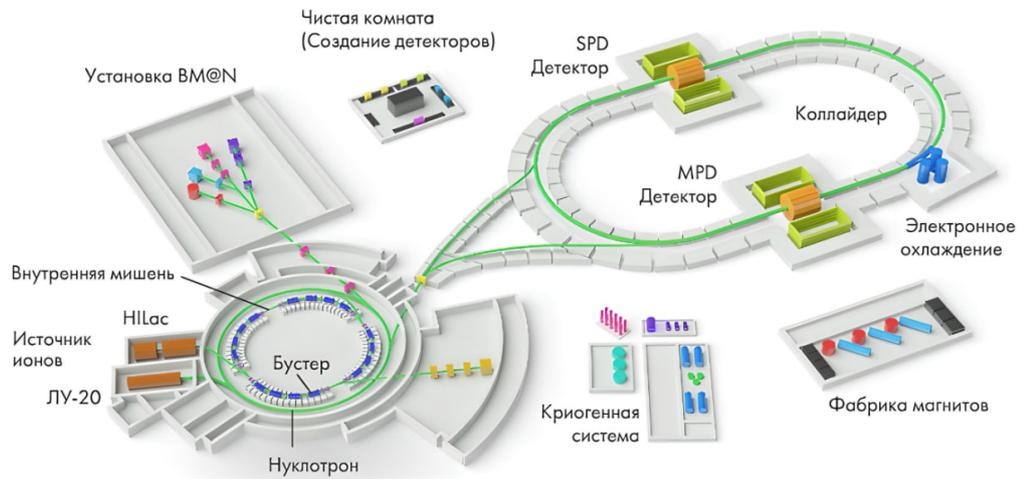
Рисунок 1 – Схема ускорительного комплекса NICA [3].
