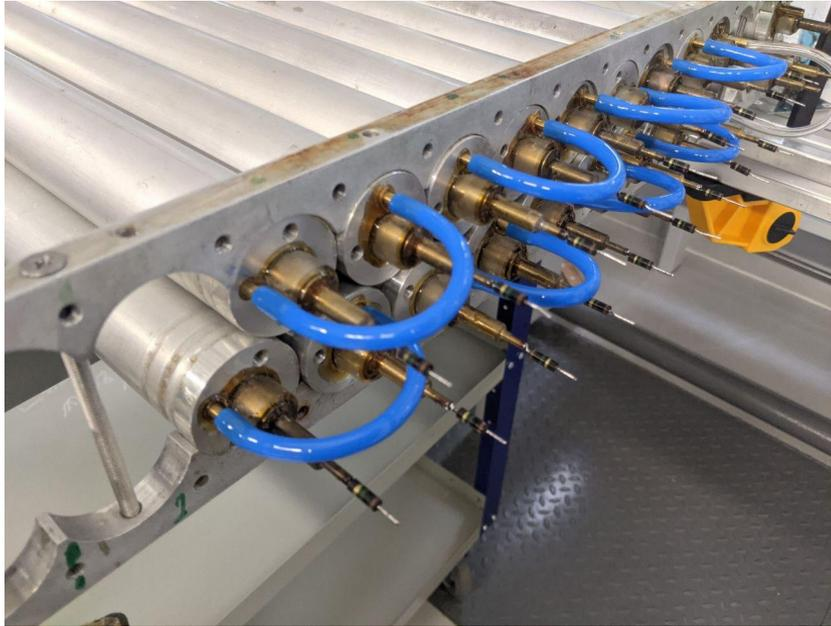
Straw трубки, соединенные рамой
