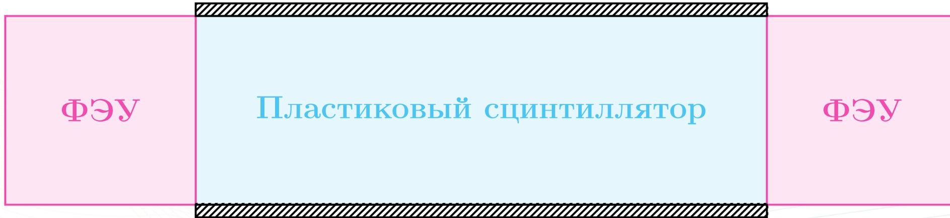
Функциональный вид спектрометра
