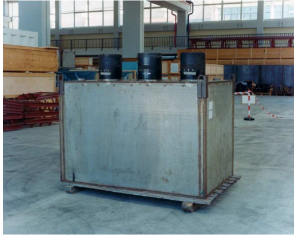
Рисунок 2.3 — Внешний вид счетчика установки LVD
