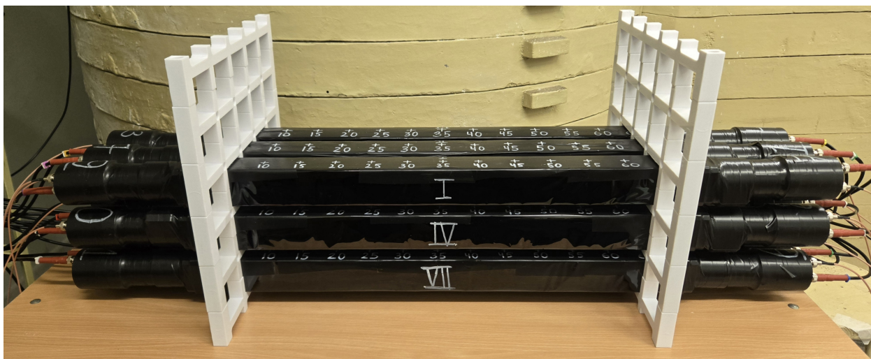
Рисунок 2.12 — Фотография собранной сборки. Отсутствует нейтронная часть, а также калибровочные каналы.
