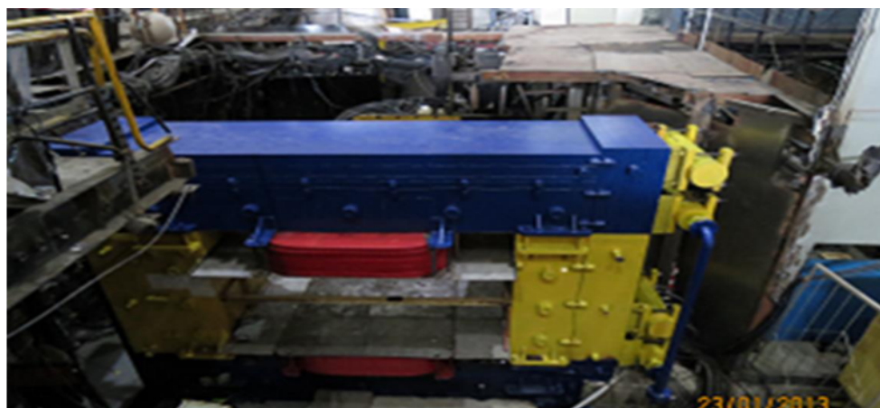
Рис. 2. Спектрометрический магнит М31 (по материалам диссертации).
