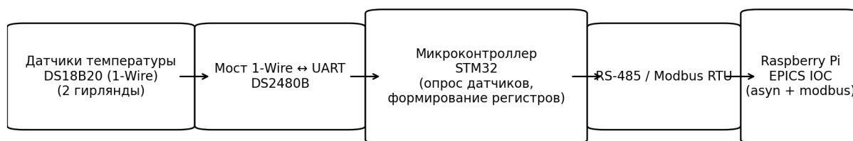
Рис. 10. Логическая цепочка формирования PV температурного мониторинга M31: две независимые шины 1-Wire (DS18B20) → драйвер/трансивер 1-Wire → STM32 → Modbus RTU/RS-485 → Raspberry Pi (IOC EPICS).
