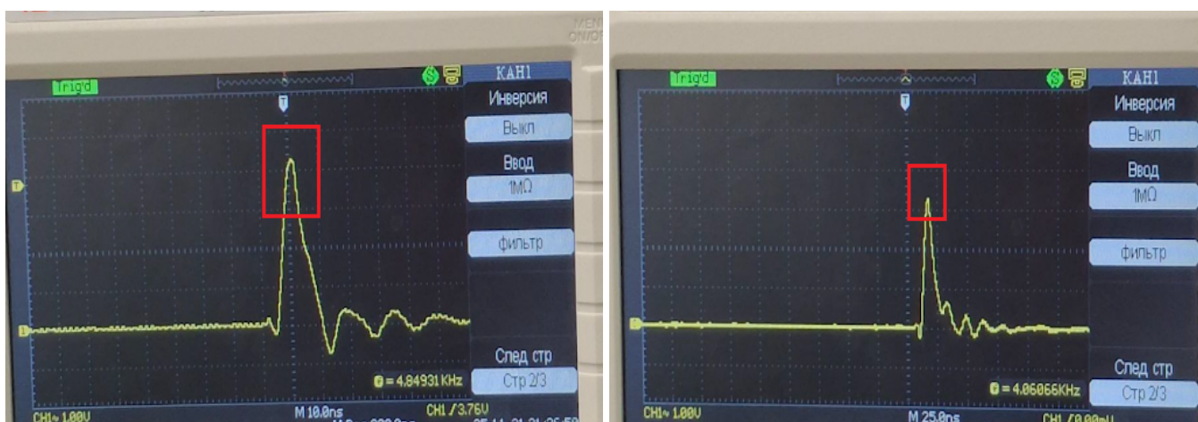
Рис.11 – Сигналы с LED-драйвера
