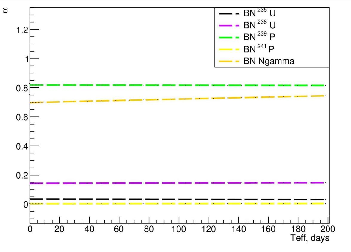
Зависимость долей деления  $\alpha(t)$  в БН-800: 235U (—), 238U (—), 239Pu (—), 241Pu (—) и  $(n, \gamma)$  (—) с 100 % МОКС топлива
