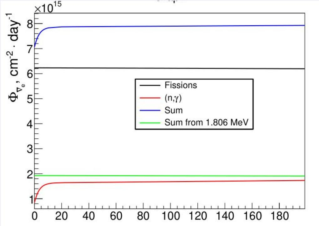
Поток  $\nu e$  от реактора БН-800 на протяжении топливной кампании для реакций деления (—),  $(n, \gamma)$ -реакций на  $^{238}\text{U}$  (—), суммарного потока (—), а также суммарного потока, превышающего порог реакции обратного  $\beta$ -распада на протоне (—) с 50 % МОКС топливом
