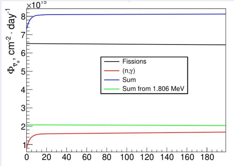
Поток  $\nu_e$  от реактора БН-800 на протяжении топливной кампании для реакций деления (—),  $(n, \gamma)$ -реакций на  $^{238}\text{U}$  (—), суммарного потока (—), а также суммарного потока, превышающего порог реакции обратного  $\beta$ -распада на протоне (—) с 16 % МОКС топливом
