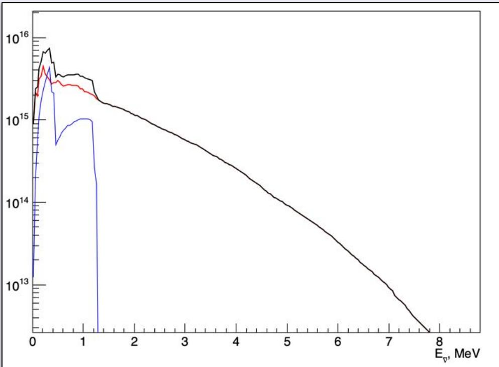
Спектры  $\nu_e$  для середины кампании реактора БН-800, обусловленные реакциями деления (—),( $n, \gamma$ )-реакциями на  $^{238}U$  (—) и их сумма (—) с загрузкой 16 % МОКС
