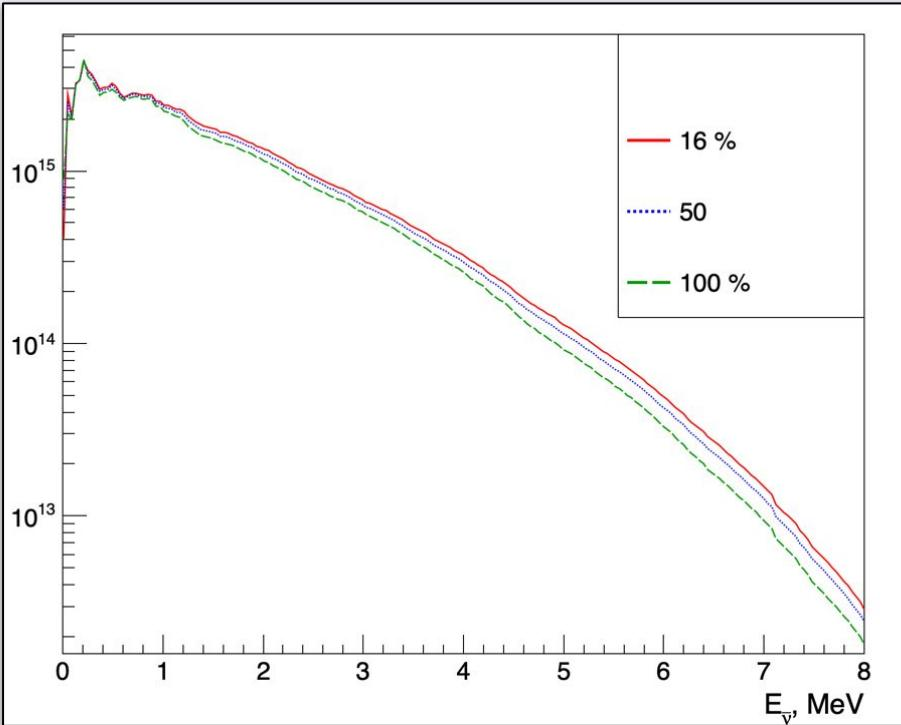
Спектры  $\nu_e$  для середины кампании реактора БН-800, обусловленные реакциями деления при 16 % МОКС (—), при 50 % МОКС (—), при 100 % МОКС (—)
