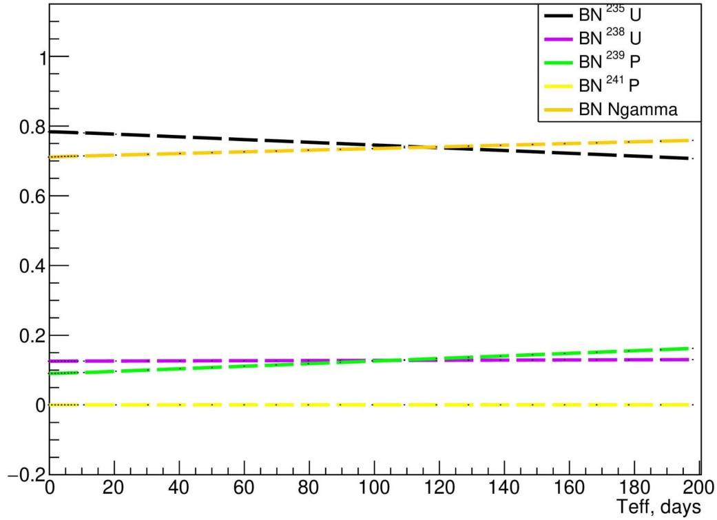
Зависимость долей деления  $\alpha(t)$  в БН-800: 235U (—), 238U (—), 239Pu (—), 241Pu (—) и  $(n, \gamma)$  (—) с 16 % МОКС топлива
