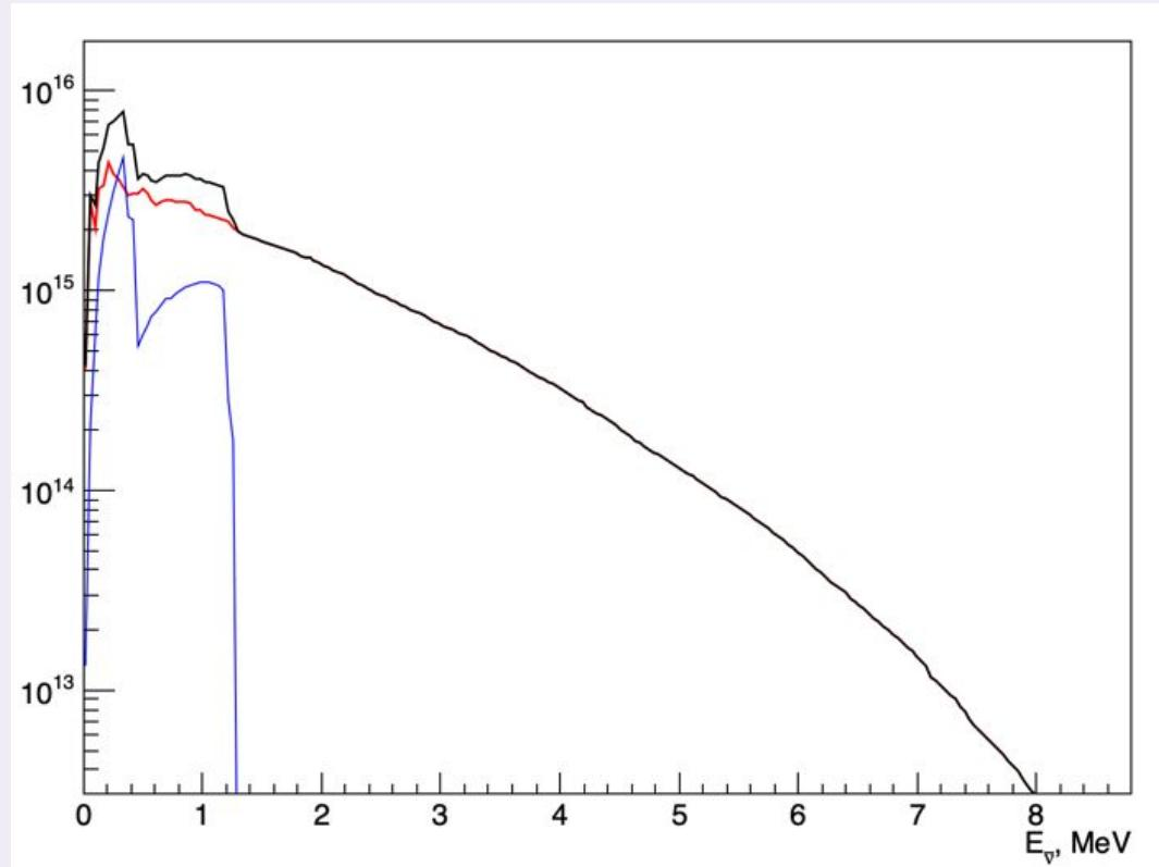
Спектры  $\nu_e$  для середины кампании реактора БН-800, обусловленные реакциями деления (—),  $(n, \gamma)$ -реакциями на  $^{238}\text{U}$  (—) и их сумма (—) с загрузкой 100 % МОКС
