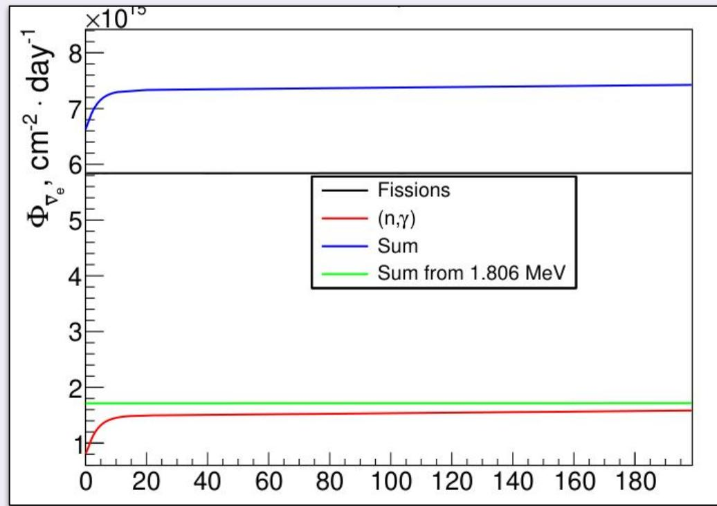
При увеличении доли смешанного оксидного топлива суммарный поток снижается на 10 % (синяя кривая).
