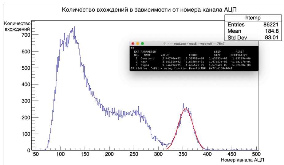
Рисунок 1.6 — Спектр источника ^{137}\text{Cs} , полученный на установке для тестирования кремниевых фотомножителей и сцинтилляционных кристаллов
