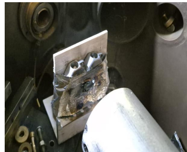
Рис. 3 - Вид повреждения детекторов
