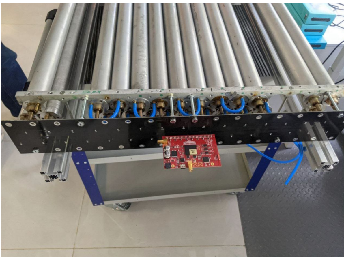
Рис. 1: Вид одного модуля детектора (Красная плата — STM-VMM)
