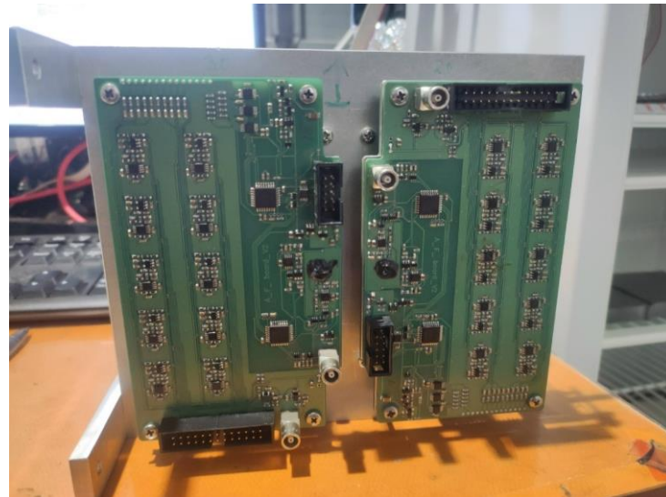
Рис. 4 - Задняя панель детектора (нумерация каналов на схеме соответствует их физическому расположению)
