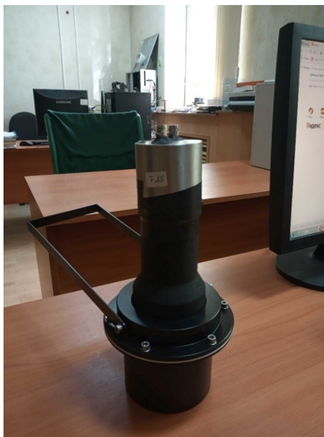
Рисунок 4 - Внешний вид сцинтилляционного детектора на основе NaI(Tl)
