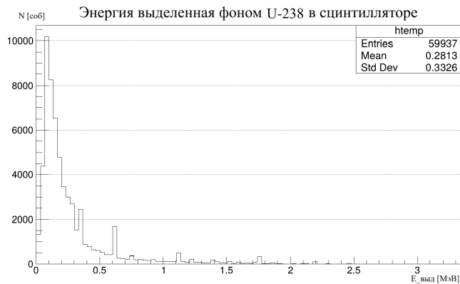
Рисунок 12 - Спектр \gamma -фона от ^{238}\text{U} без энергетического расширения
