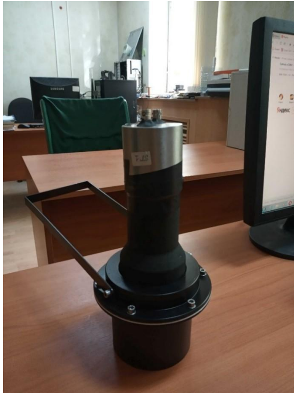
Рис.1. Детектор на основе NaI(Tl), \varnothing 9\text{см} \times 9\text{см}
