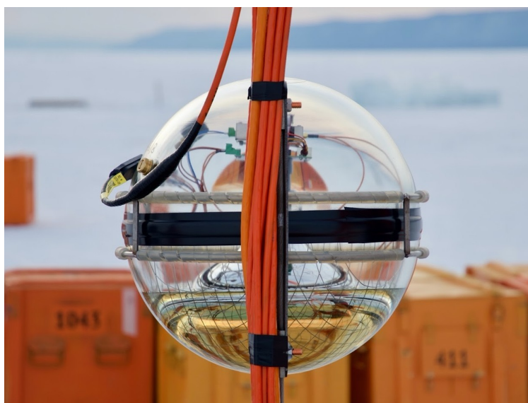
Рисунок 1.2 — Фотография оптического модуля Baikal-GVD
